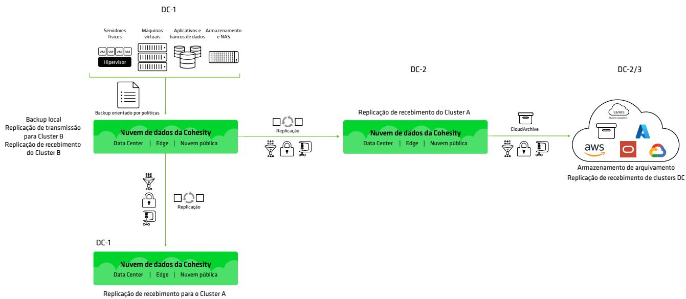
Essa arquitetura tolerante a falhas atende aos rigorosos requisitos de Objetivo de Tempo de Recuperação e Objetivo de Ponto de Recuperação e é associada a uma necessidade de retenção de longo prazo. A segunda réplica fornece recuperação de desastre adicional e proteção contra
