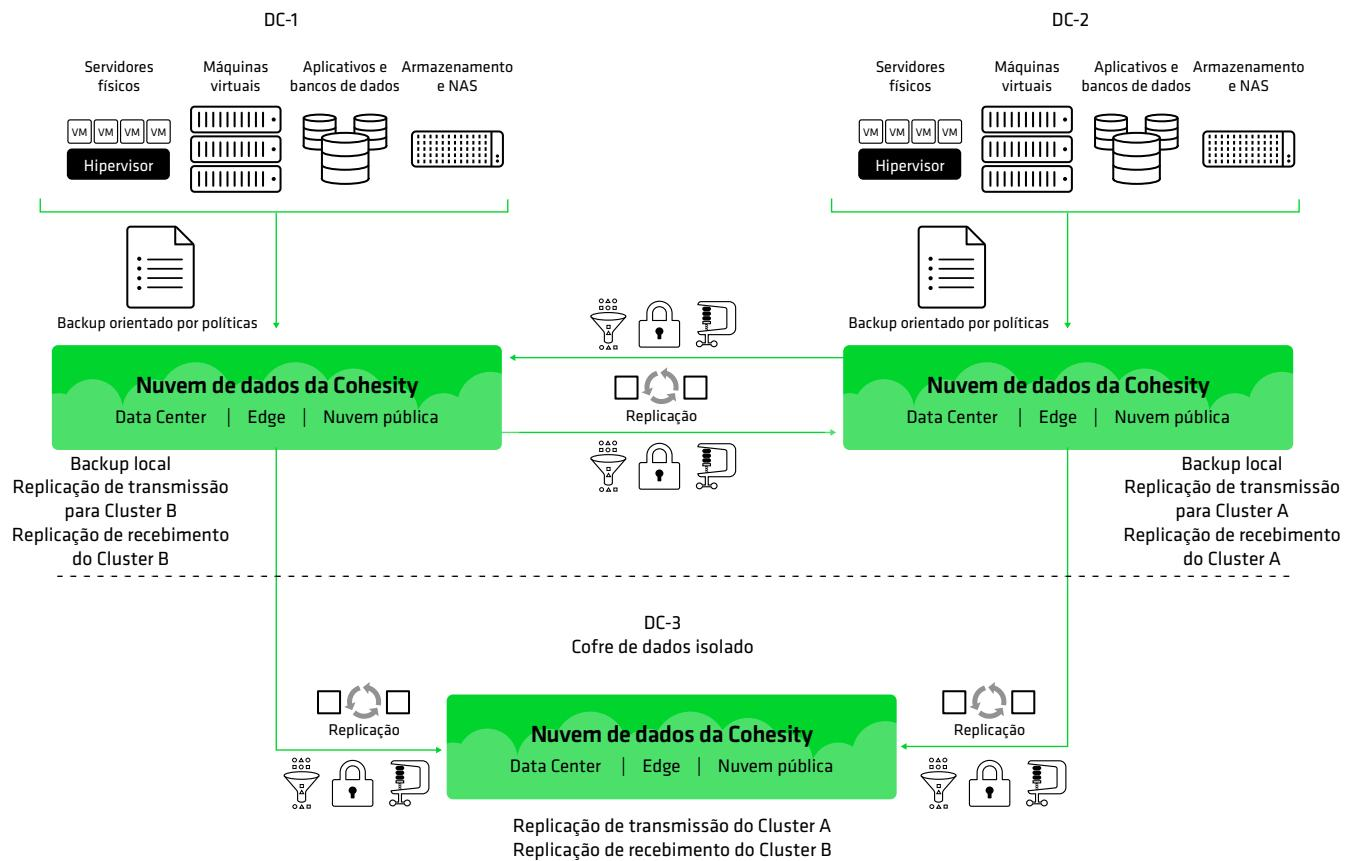
Essa topologia é outra abordagem **ativa-ativa**. Aqui, os data centers com replicação cruzada compartilham um único cofre de dados isolado. O isolamento é físico, com o cofre de dados desconectado da rede quando não está em uso. Observe que o cofre é uma réplica, permitindo uma
