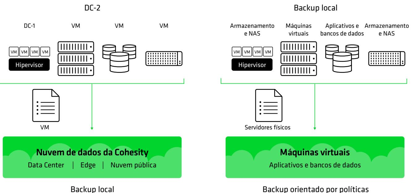
Diversos tipos e topologias são adequados a uma abordagem ativo-ativo. Uma abordagem Ativo-Ativo equivale efetivamente a duas de um único tipo de topologia, espelhadas e consecutivas. Nesta topologia, temos um par de data centers de modelo Ativo-Ativo, cada um com seu próprio backup. Qualquer um dos data centers pode assumir as operações do outro em caso de indisponibilidade. Cada data center também tem um
